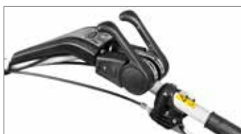
La palanca del diferencial y el inversor están en posiciones ergonómicas y se accionan fácilmente.
