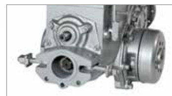
Dos tomas de fuerza, una independiente de dos velocidades y una sincronizada.
