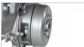
Semiejes reforzados con reductores integrados en el cambio para mayor agarre en terrenos difíciles.
