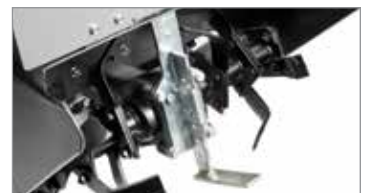
Regulación de la profundidad de la fresa para utilizarla en cualquier tipo de terreno.
