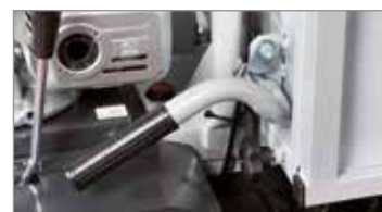
Basculamiento manual con sistema de bloqueo automático.
