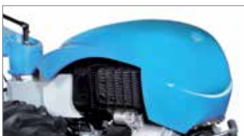
Versión monodisco, diesel, suministrada de serie con capó protector.
