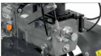
Transmisión directa por engranajes en el cigüeñal, con embrague multidisco en baño de aceite.
